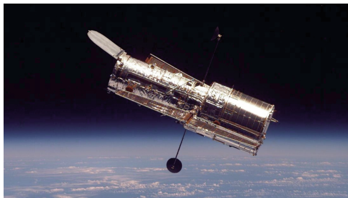
Рис. 4. Космический телескоп им. Хаббла с диаметром зеркала 2,4 м. © NASA
