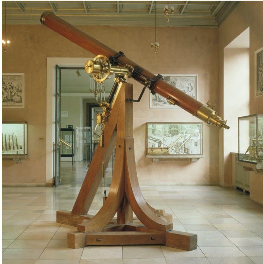
Рис. 4. Рефрактор Фраунгофера (объектив: двухлинзовый ахромат 24,4 см, фокусное расстояние: 432 см, параллактическая монтировка с часовым механизмом) Берлинской обсерватории.
