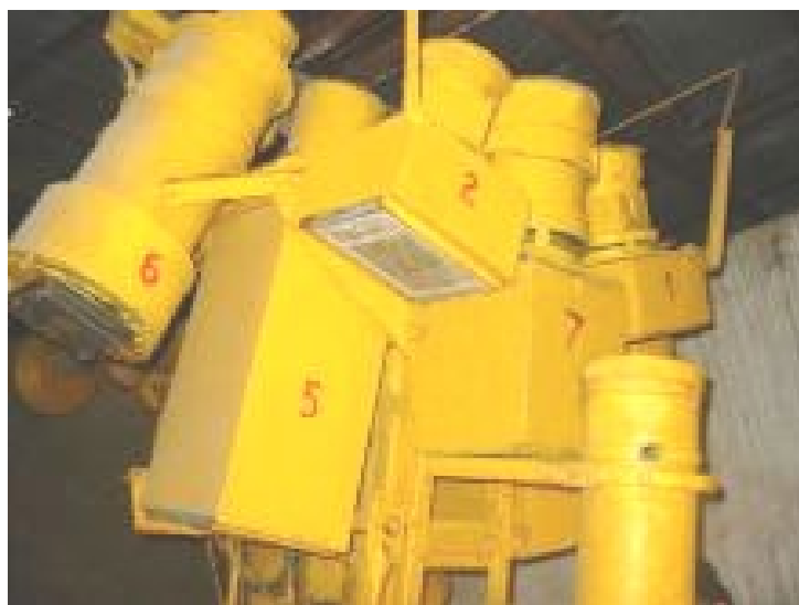
Рис. 3. Семикамерный астрограф Одесской обсерватории в с. Маяки. На этом астрографе получена значительная часть Одесской фототеки.
