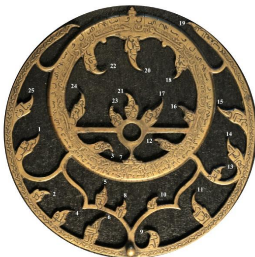
Рис. 2. Паук астролябии VC 941 из коллекции Эрмитажа. Фото автора. Звезды упорядочены по прямому восхождению: 1 – \beta Cet; 2 – \gamma Cet; 3 – \alpha Per; 4 – \gamma Eri; 5 – \alpha Tau; 6 – \beta Ori; 7 – \alpha Aur; 8 – \alpha Ori; 9 – \alpha CMa; 10 – \alpha CMi; 11 – \alpha Hya; 12 – \alpha UMa; 13 – \alpha CrI; 14 – \gamma CrV; 15 – \alpha Vir; 16 – \alpha Boo; 17 – \alpha CrB; 18 – \alpha Ser; 19 – \alpha Sco; 20 – \alpha Oph; 21 – \alpha Lyr; 22 – \alpha Aql; 23 – \alpha Cyg; 24 – \epsilon Peg; 25 – \delta Aqr.
