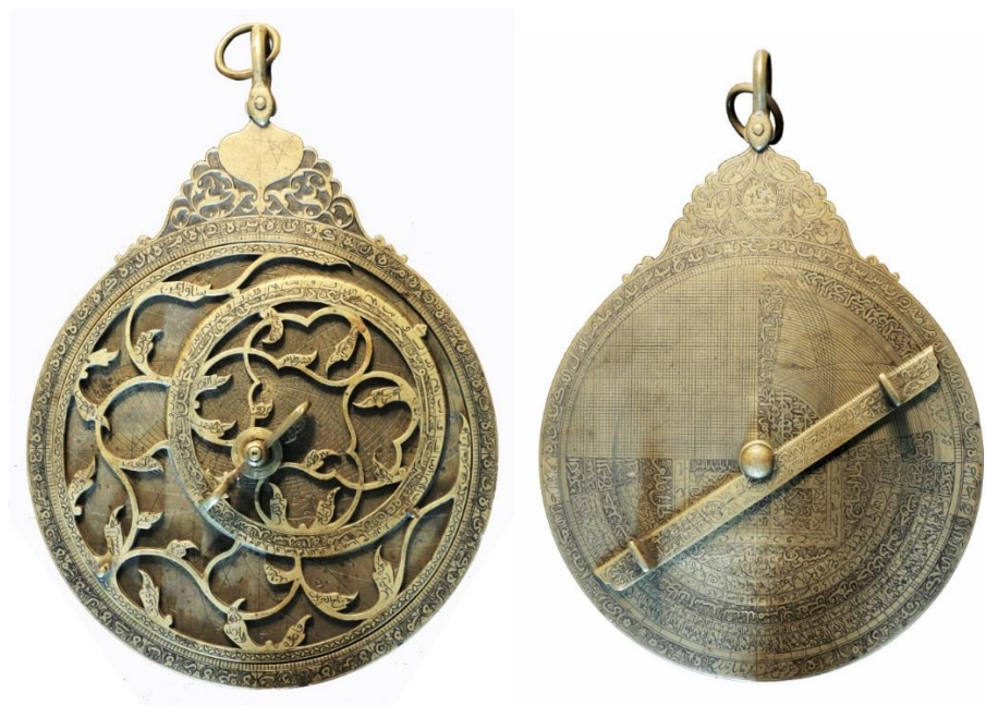
Рис. 1. Астролябия из коллекции Эрмитажа (инв. номер VC 939). Изготовлена между 1682 и 1707 гг. Диаметр 116 мм. На лицевой стороне виден паук, под ним – тимпан. На обратной стороне многочисленные шкалы и алидада. Все детали скреплены осью и штифтом. Фото автора.
